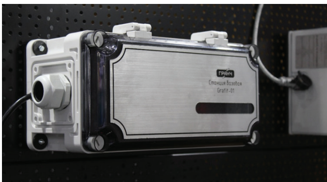
Рис. 3 Базовая станция Wi-Fi рудничная со встроенными антеннами и аккумуляторной поддержкой (производитель – ООО НПФ «Гранч», Российская Федерация)
