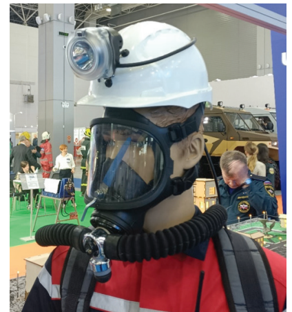
Рис. 4 На манекене горноспасателя головной шахтерский светильник с видеокамерой, функциями определения местоположения с поддержкой Wi-Fi (производитель – ООО НПФ «Гранч», Российская Федерация)
